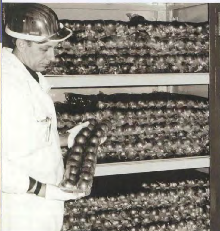
Vorratsschrank für die Brennelementkugeln
